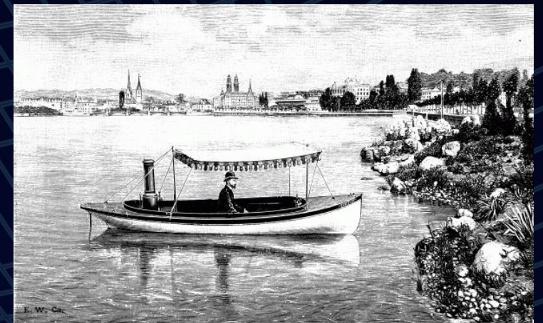
První využití organického cyklu jako pohonu říčního plavidla Naphtha engine
