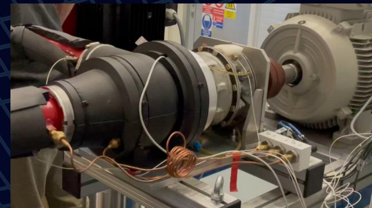
Mikro turbinka 13 kWe s generátorem
